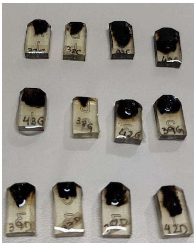
Figura 11 - Emblocamento e polimerização em resina Epon
