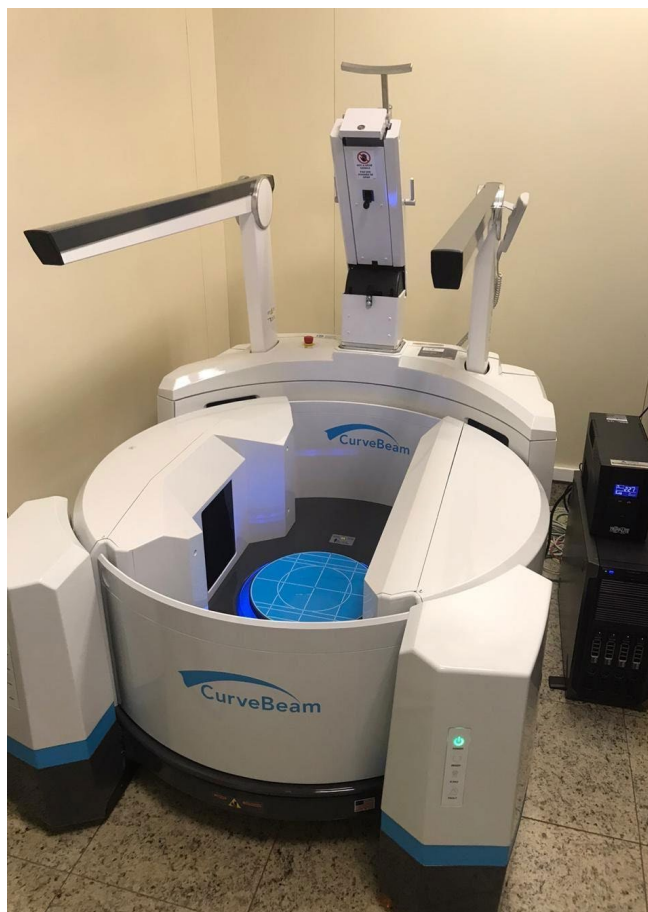
Figura 11 - Tomógrafo de feixe cônico com carga
