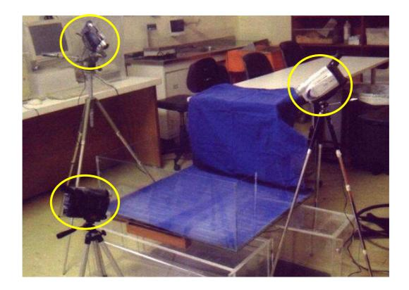
**Figura 3** - Caixa confeccionada em vidro transparente (80 x 80 x 30 cm) e posicionamento das câmeras.
