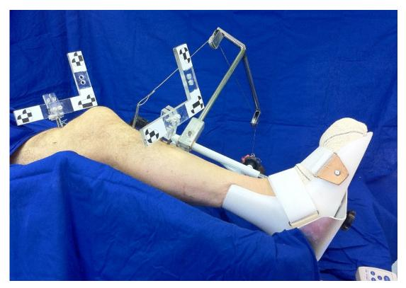
**Figura 15** - Aparelho de *"pivot shift"* instrumentado. Destaque para o sistema de cabo e polias e órtese de polipropileno no tornozelo com 15<sup>0</sup> de rotação interna
