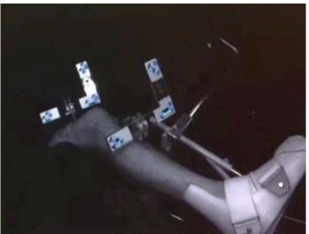
**Figura 17** - Captura simultânea do posicionamento dos marcadores ópticos por óticas distintas
