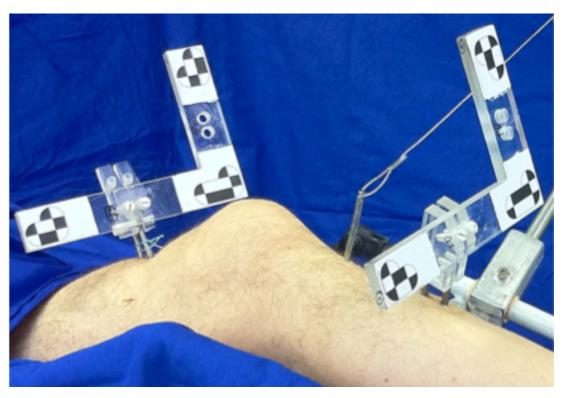
**Figura 16** - Reconhecimento óptico pela geometria dos marcadores nas estruturas de acrílico em L no fêmur e na tíbia
