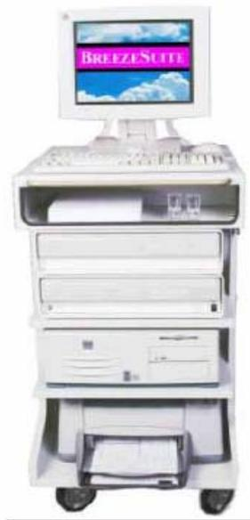
Figura 4 – Analisador metabólico de gases computadorizado respiração-a-respiração (CPX/D, MedGraphics, Saint Paul, MN, [EUA]) utilizado na avaliação ergoespiométrica no LEM-IOT/HCFMUSP.
