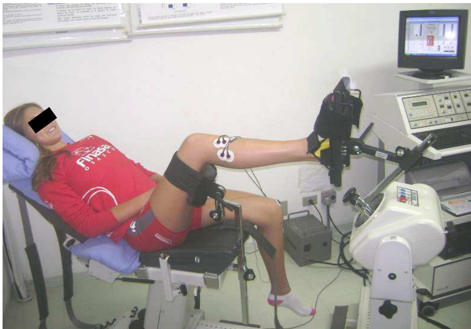
Figura 7 - Posicionamento de uma das atletas no dinamômetro isocinético para avaliação dos movimentos de eversão e inversão do tornozelo
