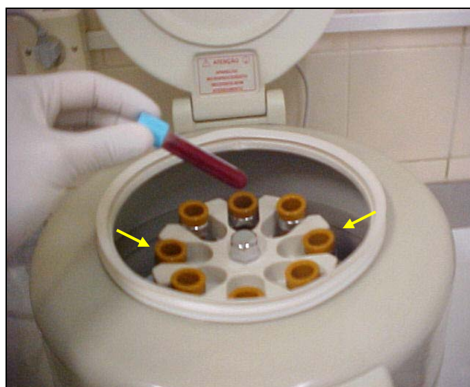
Figura 5. Tubos com sangue total acondicionados na centrífuga com 15 cm de raio e com cruzetas horizontais (8x15 mL) posicionadas de forma oposta e equidistantes ao centro
