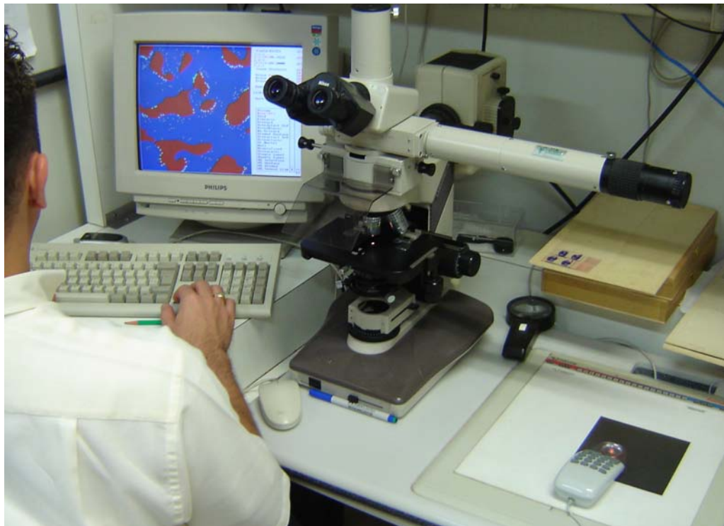
Figura 16. Equipamento utilizado para análise histomorfométrica (microscópio acoplado a placa digitalizadora e software Osteomeasure®)
