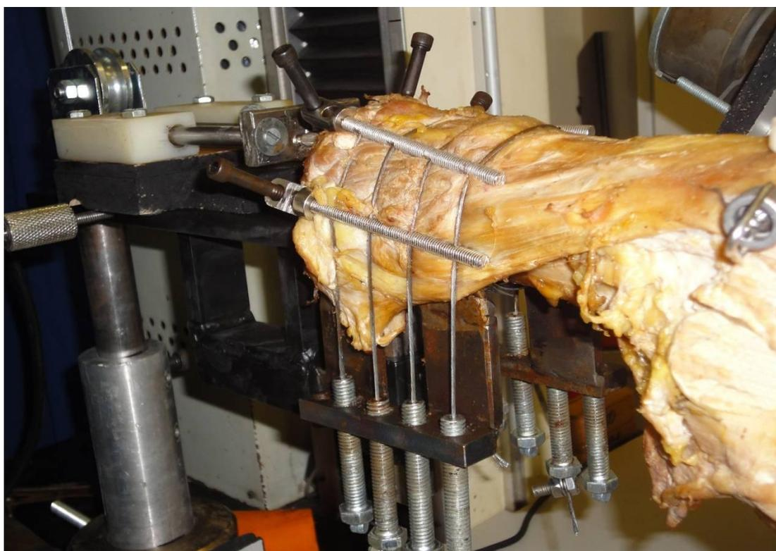
**Figura 4.** Garra quadricipital utilizada para a fixação do quadríceps através dos oito parafusos canulados e quatro cabos de aço.
