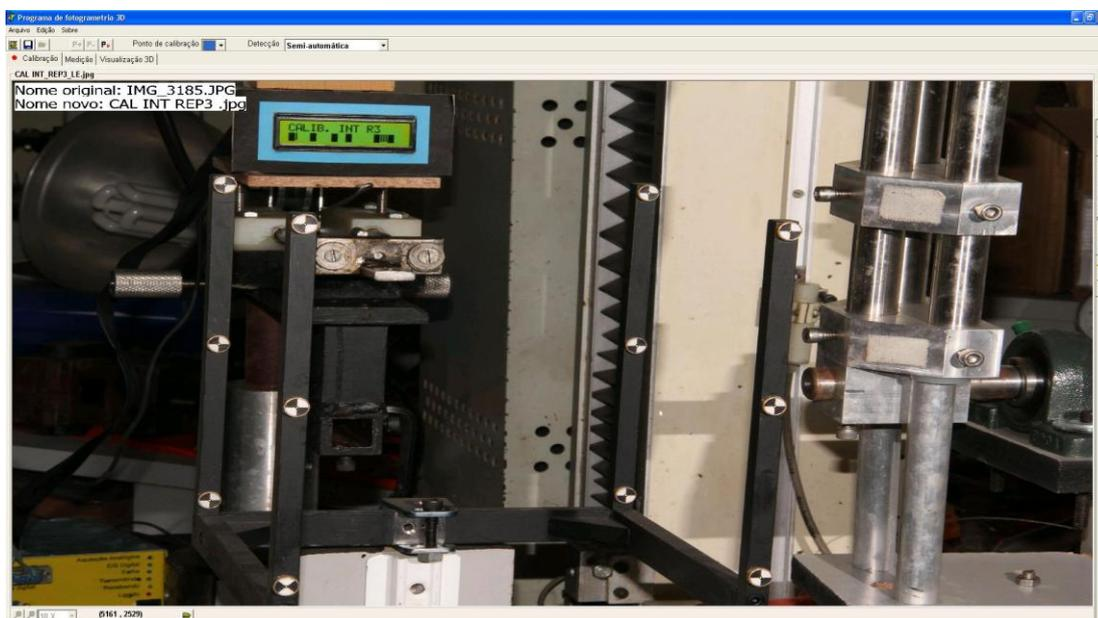
**Figura 13.** Tela do programa de fotogrametria 3D mostrando o processo de calibração dos centros dos marcadores do calibrador na foto tirada à esquerda do dispositivo.
