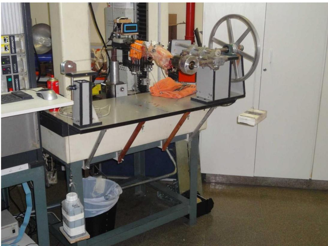
**Figura 5.** Joelho direito fixado no dispositivo mecânico evidenciando o peso acoplado à polia (à direita) e o peso utilizado para lateralizar a patela (à esquerda)
