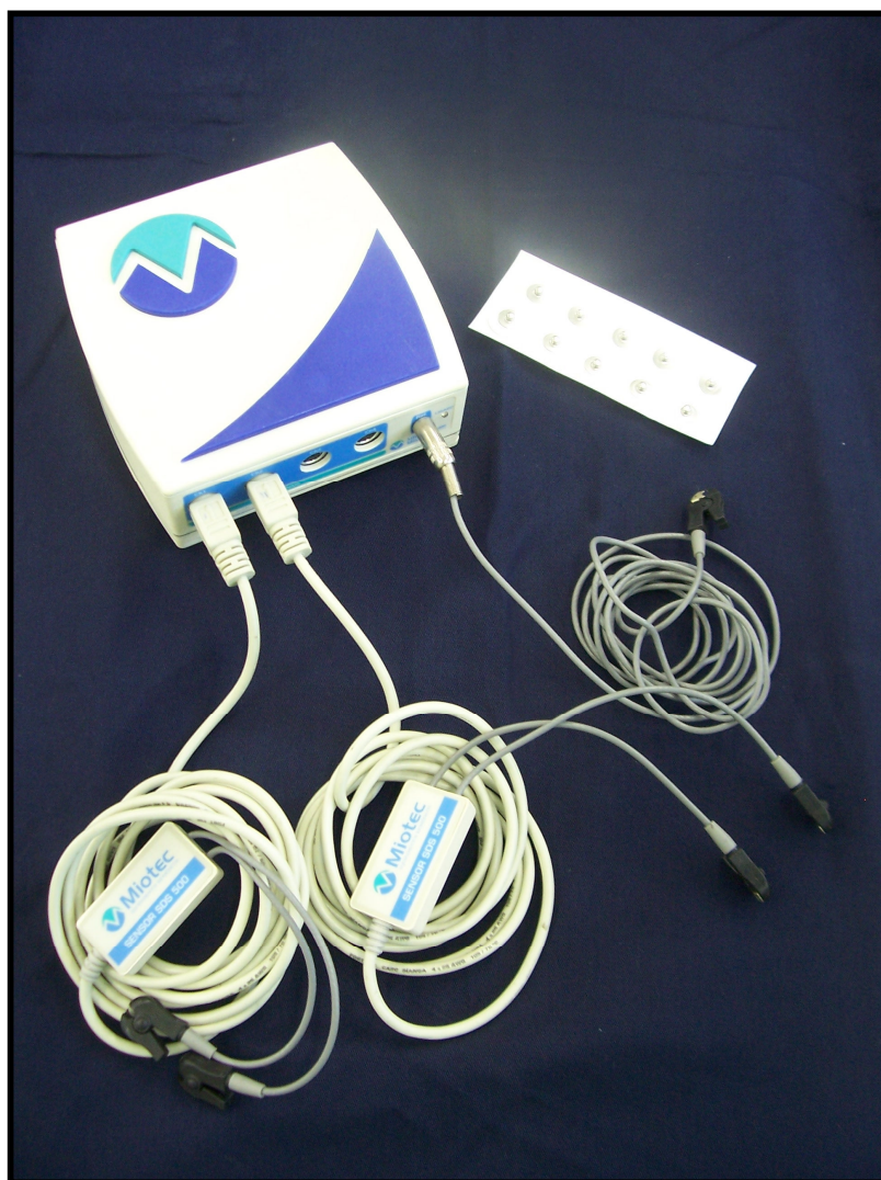
Figura 1 Eletromiógrafo de superfície marca Miotec, modelo Miotool 400®, de 4 canais, com 14 bites de resolução de faixa dinâmica
